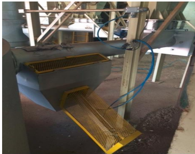
FIGURA 2 – Dispositivo Eletropneumático de Abertura Automática, que elimina o sabugo da rosca.
